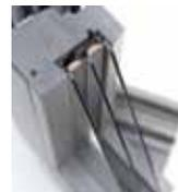
Alle naturali proprietà isolanti del legno si abbinano soluzioni costruttive che garantiscono la massima protezione in tutte le stagioni. Vetrocamera di ultima generazione con gas argon, canaline "warm edge" in acciaio inossidabile e polipropilene con una capacità isolante doppia rispetto alle normali canaline in alluminio, soglie a taglio termico e guarnizioni maggiorate.
